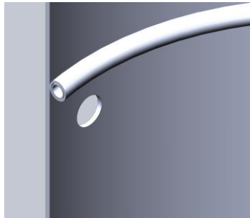
1. Выполняется сверление отверстия диаметром 50 мм
